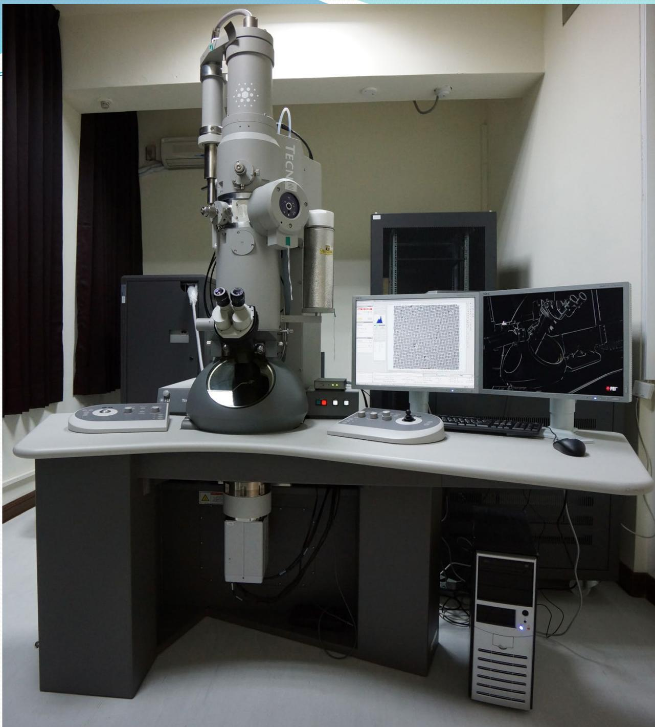
穿透式電子顯微鏡
